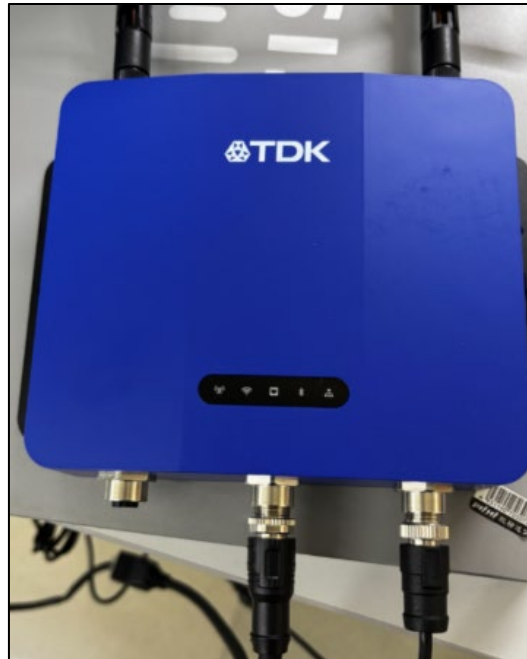
図 12:ゲートウェイの電源接続
