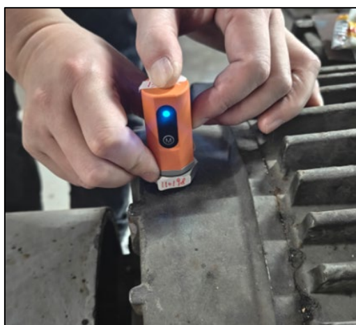
図 9: 設備にセンサを接着
