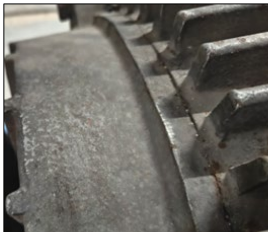
図 6:設備の設置表面の付着物の除去
