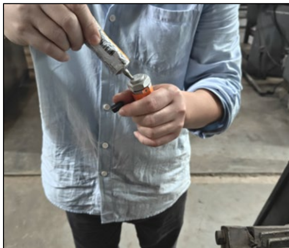
図 8: センサの取付プレートに接着剤を塗布
