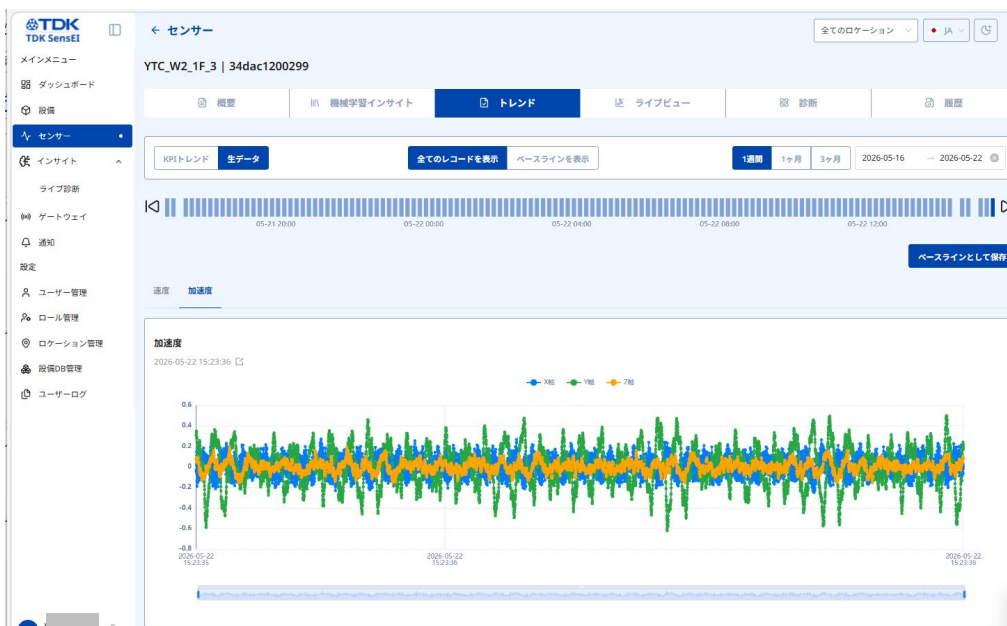
図 83:生データ加速度 (センサー)
