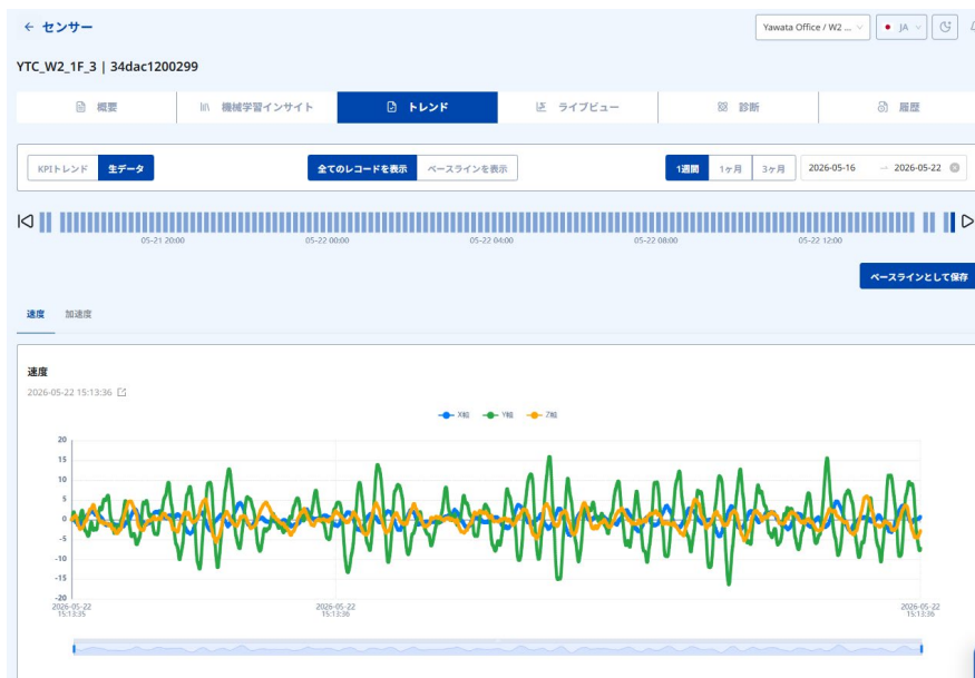
図 80:生データ速度波形 (センサー)
